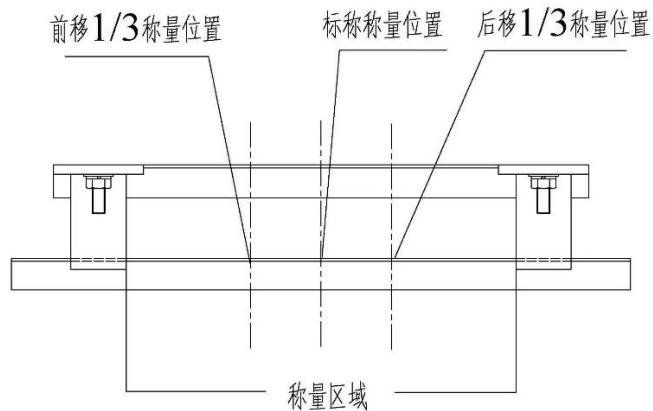
按文件8.2.5进行载荷在不同位置误差试验，按附录A填写校准记录并计算误差，验证载荷在不同位置误差试验方法及判定要求的合理性。
